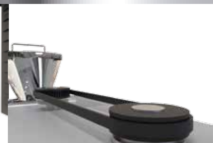
Transmisión por correa dentada Toothed belt transmission
