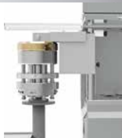
Sistema de extracción de cabezal Turret head removal system
